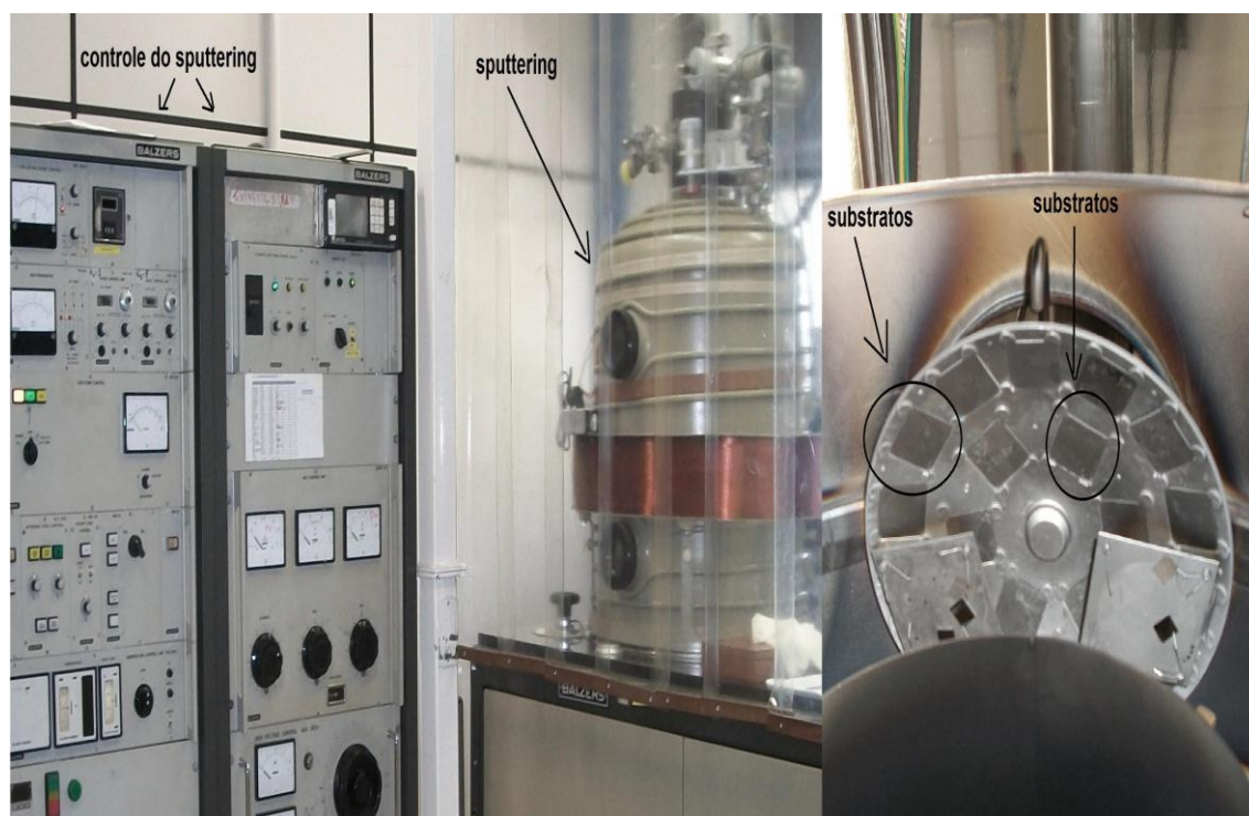
Figura 2.6 À esquerda: vista externa do aparelho de DC Magnetron sputtering utilizado neste trabalho. À direita: vista interna do ânodo do aparelho, onde é possível ver os diversos substratos de aço onde os filmes de TiNbZr foram posteriormente depositados.
