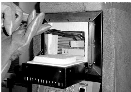
Figura 5.7: Forno para aquecimento de amostras para ensaio de choque térmico em água. Foto extraída do trabalho de Cintra [52].
