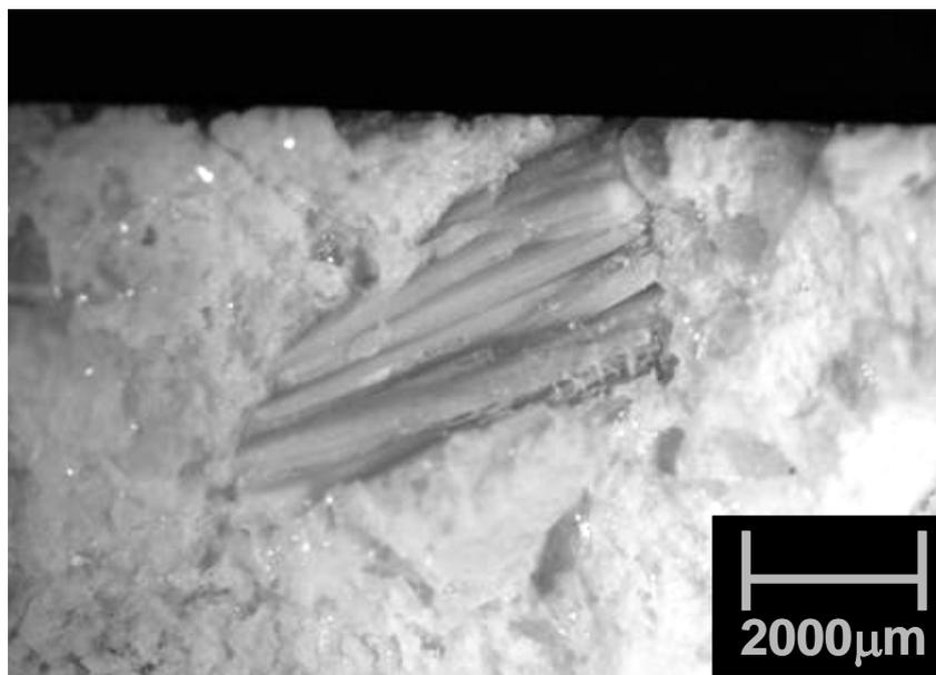
Figura 6.39: Agregado eletrofundido de mulita-zircônia fraturado transgranularmente observado em estereomicroscópio. Textura de “feixe de bastões”.
