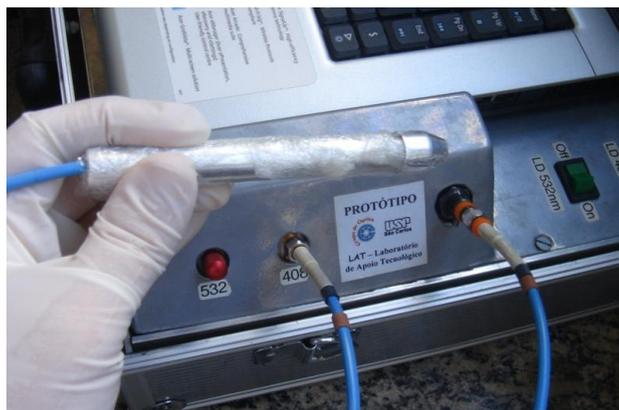
Figura 8. Sistema utilizado para aferição da Espectroscopia de Fluorescência (LEMOS, 2010).
