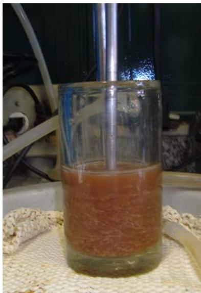
Figura 7. Reator encamisado com caroço de açai em água destilada
