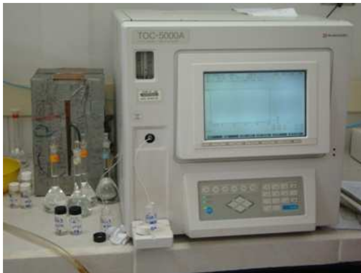
Figura 15: Equipamento da marca Shimadzu TOC 5000A (Total Organic Carbon Analyzer) para determinação de COD.
