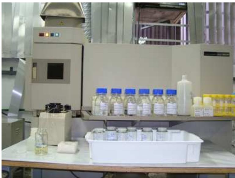
Figura 19: Espectrômetro de emissão óptica com plasma acoplado indutivamente (ICP-OES) utilizado na determinação das bases trocáveis do solo, P e metais.
