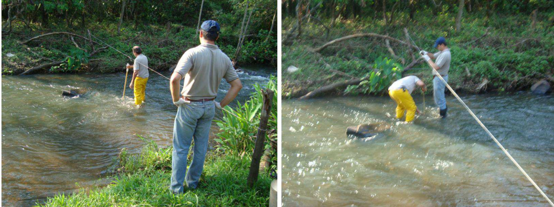
Figura 16: Determinação da velocidade média de fluxo da água e das distâncias entre o barbante e o fundo do leito do ponto P9 do Ribeirão Guamium para caracterização da seção transversal do rio.
