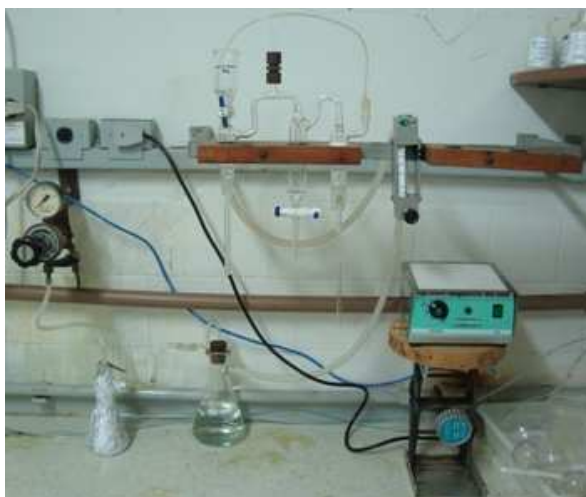
Figura 23: Sistema analítico utilizado para a determinação de AVS e extração simultânea de metais pesados.
