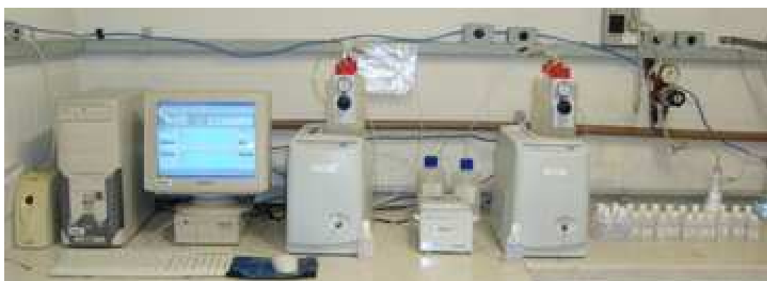
Figura 14: Cromatógrafo iônico Dionex ICS-90 utilizado para as análises de íons.
