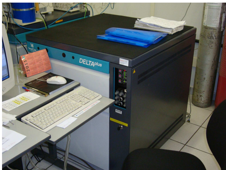
Figura 21: Espectrômetro de massas para razões isotópicas da marca ThermoQuest-Finnigan, modelo Delta Plus Finnigan.
