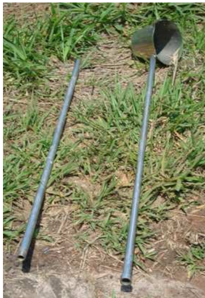
Figura 22: Copo constituído em aço inoxidável para a coleta do sedimento de fundo (ARMAS, 2006).
