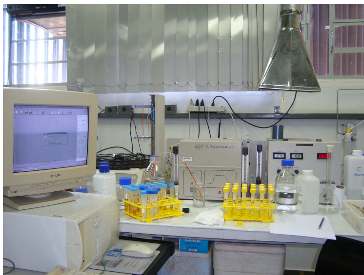
Figura 18: Espectrômetro de fluorescência atômica (AFS) utilizado na determinação do elemento químico arsênio (As).
