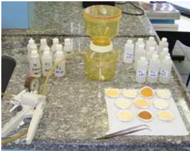
Figura 13: Sistema de filtração manual à vácuo para amostras de água.
