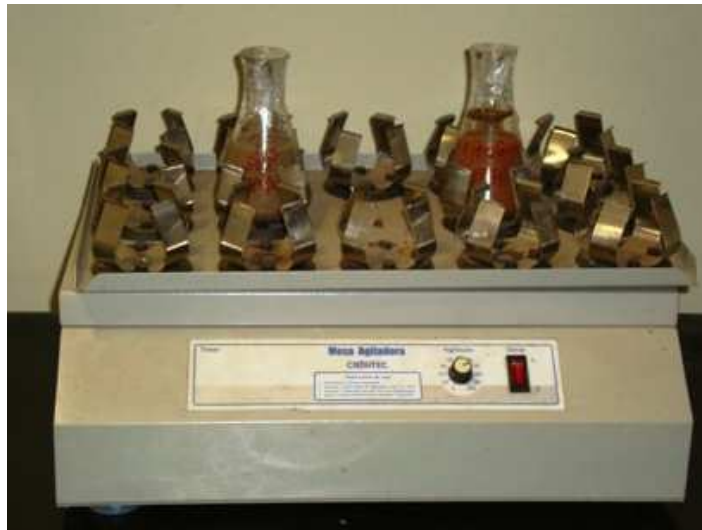
Figura 24: Obtenção do solubilizado do sedimento de fundo na mesa agitadora.
