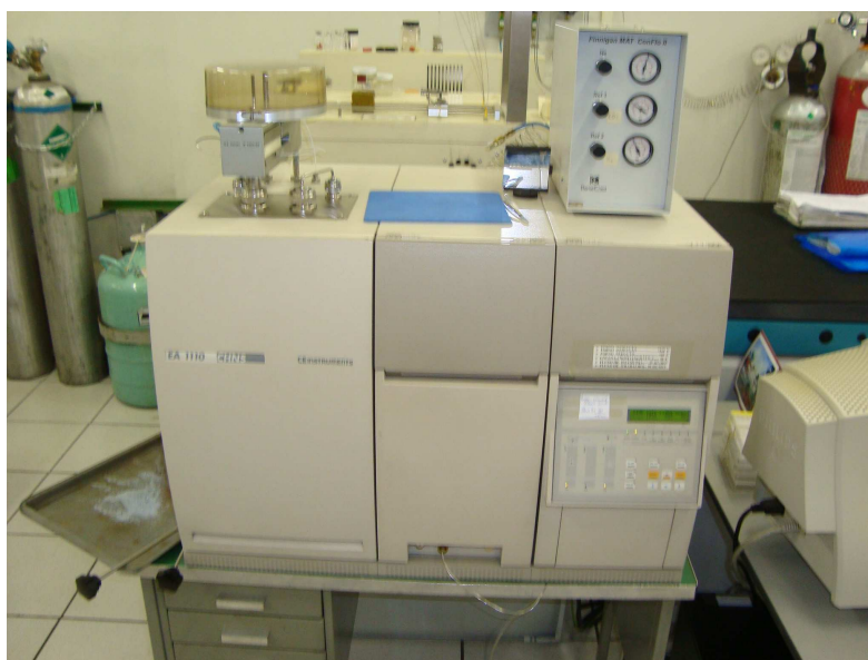
Figura 20: Analisador elementar (gerador de gases) da marca Carlo Erba – modelo EA 1110 CHNS.
