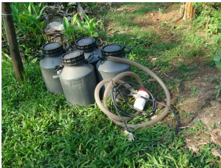
Figura 17: Frascos escuros de polietileno resistente e bomba pneumática para a coleta do material em suspensão.
