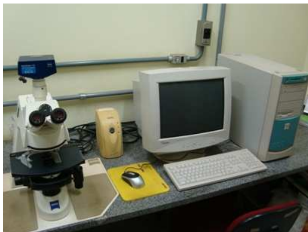
Figura 29: Vista geral do microscópio óptico e sistema de aquisição de imagens.
