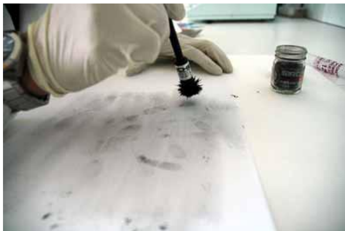
Figura 16: Ilustração da utilização da técnica do pó na revelação de uma impressão digital. Disponível em: http://www.quimica.net/emiliano/artigos/2006dez_forense1.pdf . Pesquisado em 11/09/2012, as 20h15
