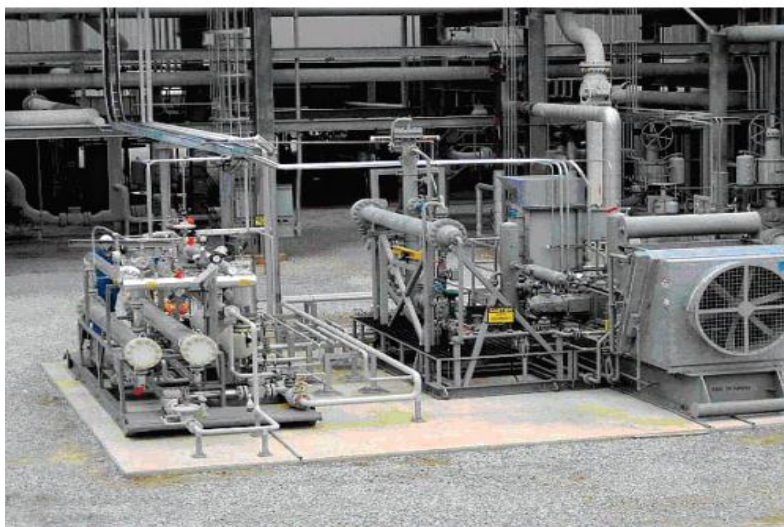
Figura 2.8: Acima: Diagrama de bloco de um processo de membrana para separação de hidrocarbonetos; Abaixo: Foto do módulo de membranas representado pelo diagrama de blocos [21].
