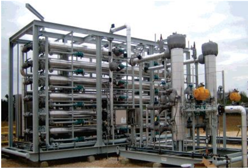
Figura 2.7: Fotografia de um módulo de membranas utilizado para a remoção de \text{CO}_2 em fluxos de gás natural [21].
