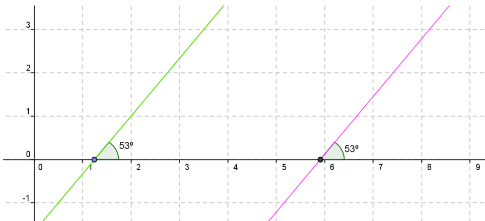
Figura 40: Condição de paralelismo entre duas retas.
