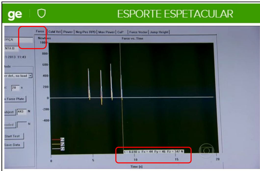
Figura 31. Software utilizado para medir a força aplicada nos golpes.
