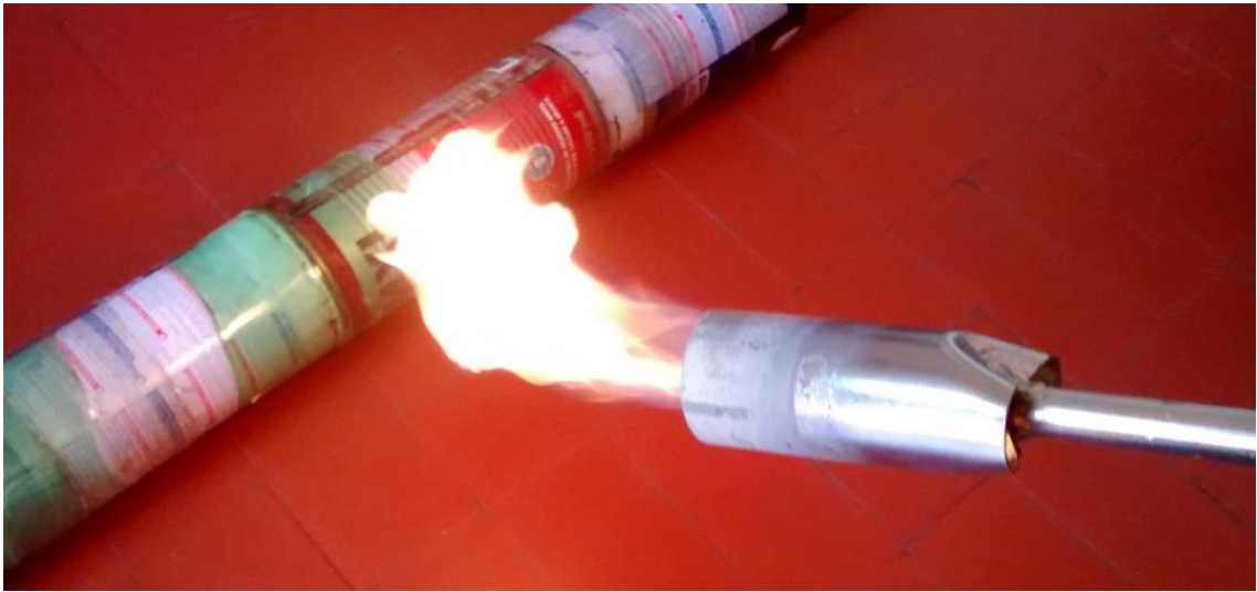
Figura 10: Vassoura de fogo, (maçarico).
