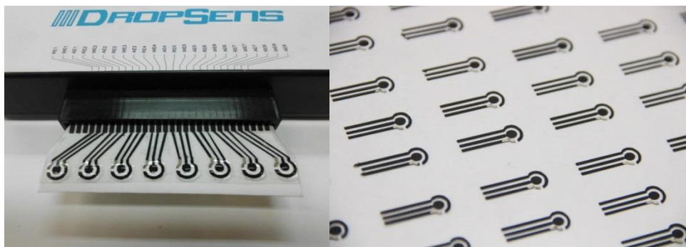
FIGURA 1. 7: Células eletroquímicas descartáveis desenvolvidas por AFONSO et al. Extraído e adaptado da referência 82.
