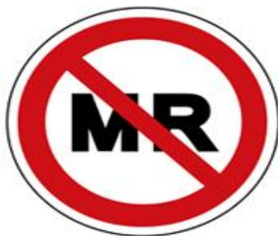
Figura 22: Símbolo ASTM não seguro para RM. O exame não pode ser realizado sob nenhuma circunstância
