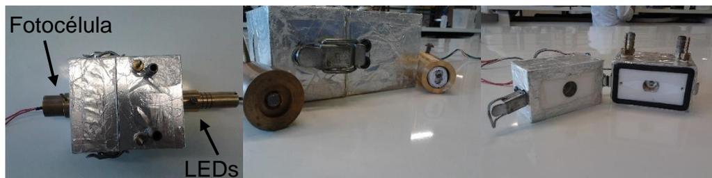
Figura 4-37 Fotos do colorímetro instalado em matriz de bancada. Matriz de Teflon® recoberta com filme de alumínio.
