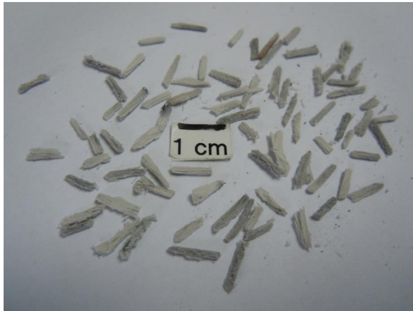
Figura 5.14 Imagem das fibras de vidro residuais após o ensaio de teor de cinzas da amostra PVC20FV, coletada de um corpo de prova tipo barra.
