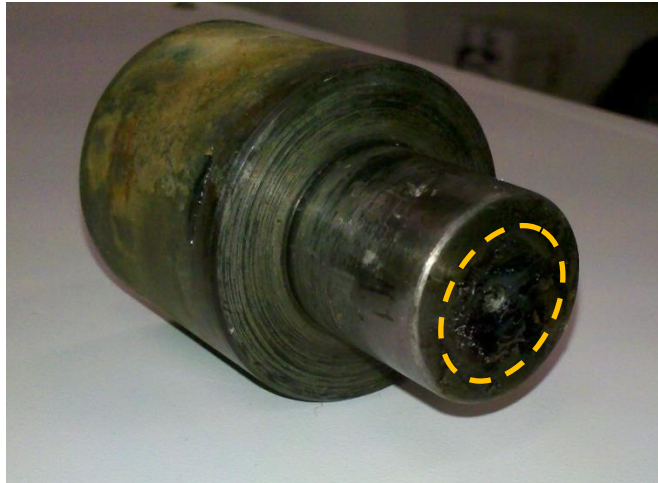
Figura 4.3 Composto de PVC estagnado no macho da matriz de revestimento. Visão da saída do roving de vidro\material fundido.
