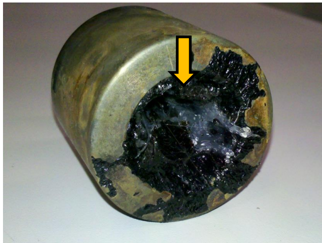
Figura 4.4 Composto de PVC estagnado no macho da matriz de revestimento. Visão da entrada do roving de vidro\material fundido.
