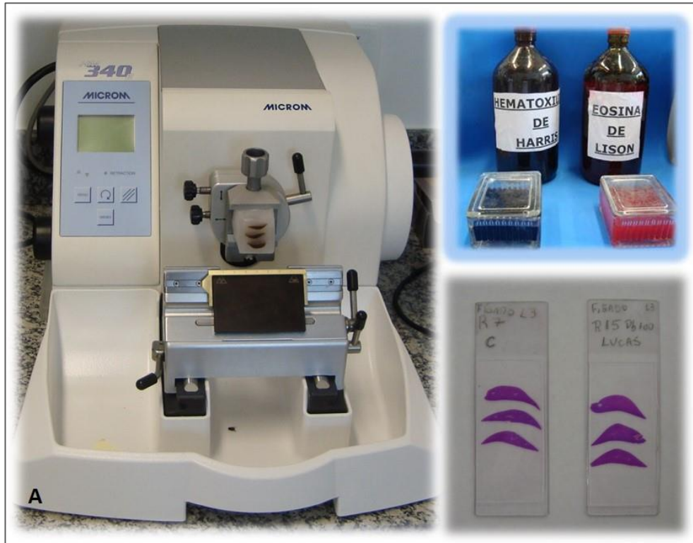
Figura 2. Microtomia das peças e coloração dos cortes. A) Micrótopo (Microm, modelo HM 340 E, Alemanha) utilizado para realização dos cortes histológicos. B) Corantes H&E. C) Lâminas identificadas com cortes teciduais.
