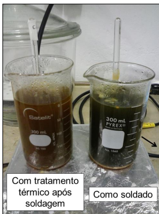
Figura 5.26 Ensaio de imersão em \text{FeCl}_3 após 24 h a 50 °C.
