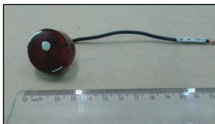
Figura 4.6 Eletrodo de trabalho utilizado na realização dos ensaios eletroquímicos.
