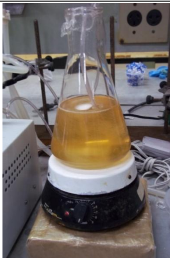
FIGURA 4.20 - Preparação do meio de cultivo para bactérias anaeróbias redutoras de ferro.
