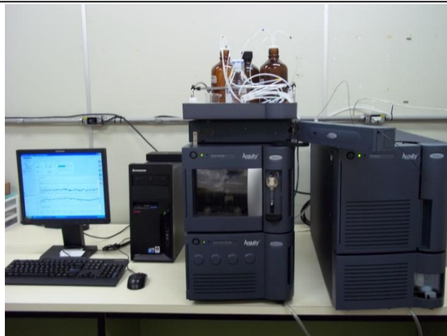
FIGURA 4.16 - Cromatógrafo líquido de alta eficiência acoplado a um detector triplo quadrupolo da Waters ® . Fonte: Fotografia feita pela autora no LBGqA/DQ/UFSCar.
