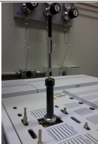
FIGURA 4.8- Etapa de dessorção dos compostos da fibra a 200°C.
