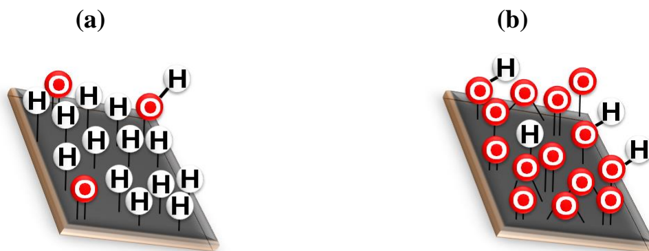
FIGURA 1.5 - Representação da superfície do BDDE com as diferentes terminações superficiais provocadas pelos pré-tratamentos eletroquímicos (a) catódico e (b) anódico.
