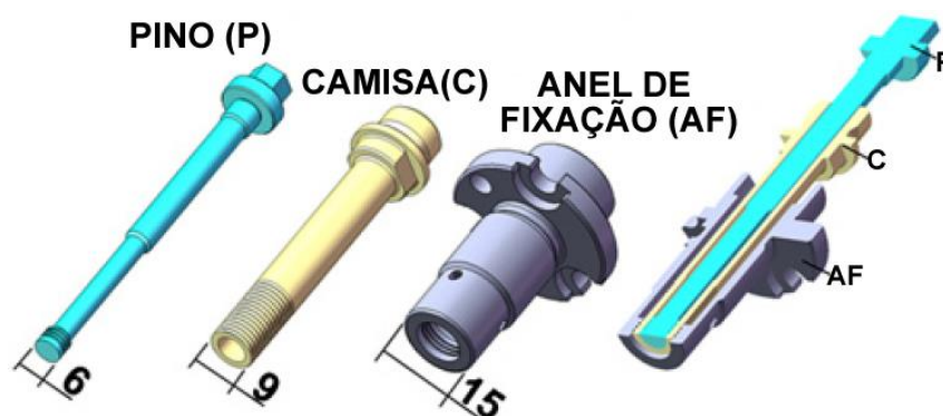
Figura 2.17: Ferramentas utilizadas no equipamento de FSpJ com as respectivas dimensões. Adaptado de [9].
