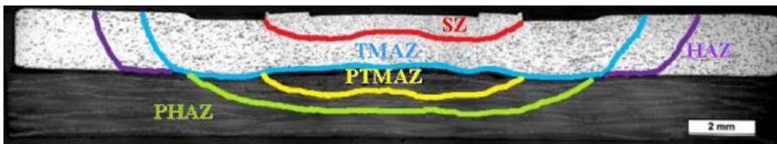
Figura 2.20: Macrografia da seção transversal de uma junta metal-compósito polimérico com delimitação esquemática das zonas afetadas na junta. Reproduzido de [52].
