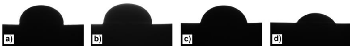
Figura 4.33: Influência do tratamento superficial do alumínio no ângulo de contato do PPS fundido: a) tal como recebido; b) lixamento + \text{HNO}_3 por 30 min.; c) \text{HNO}_3 por 30 min. d) lixamento P1200
