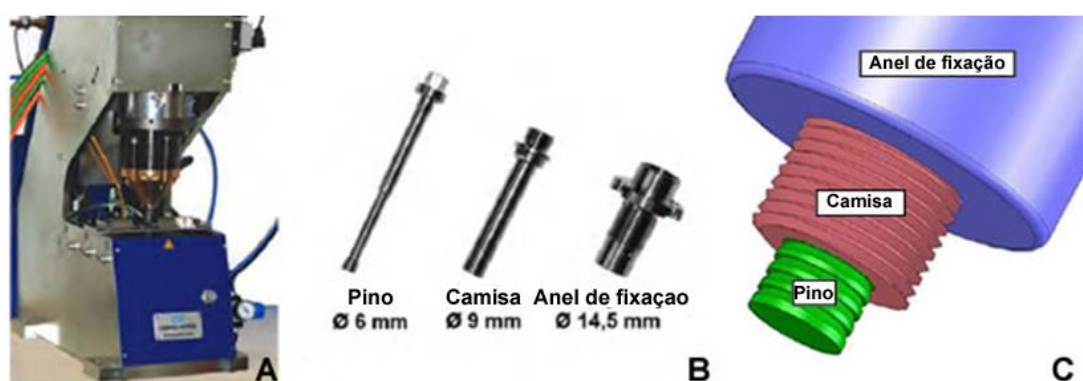
Figura 3.5: A) Equipamento FSpJ; B) Geometria das ferramentas; C) Detalhes das ferramentas de FSpJ. Adaptado de [46] [10]
