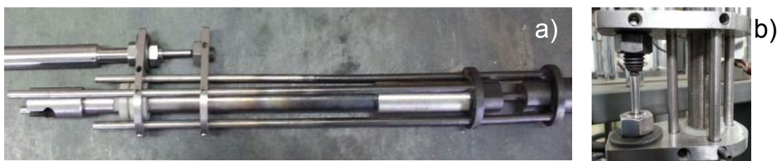
Figura 3.6 – a) Detalhes do sistema de transferência da deformação do corpo de prova e b) detalhe da localização do LVDT.
