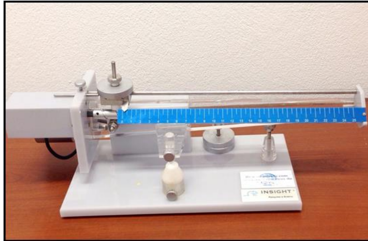
Figura 4: Randall-Selitto tes (Insight® , Equipamentos Científicos Ltda, Brasil). Instrumentos utilizados para as avaliações de hiperalgesia mecânica, através do limiar de retirada da pata.
