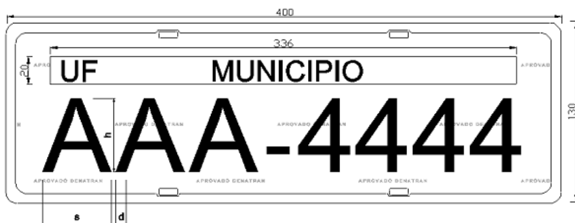
Figura 2.28: Dimensões para placas de identificação de veículos. Extraído de (CONTRAN, 2007).
