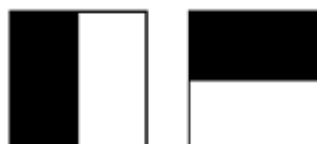
Figura 2.18: Filtros Haar Wavelets para calcular a resposta em x (esquerda) e y (direita). Extraído de (BAY et al., 2008).
