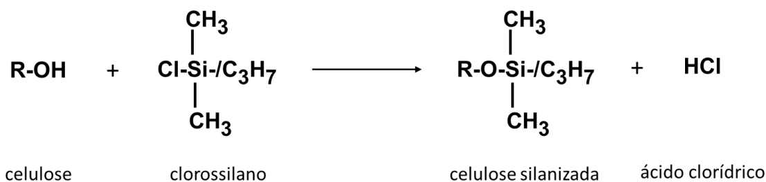
Figura 2.19 - Reação do isopropildimetilclorossilano e celulose [49].
