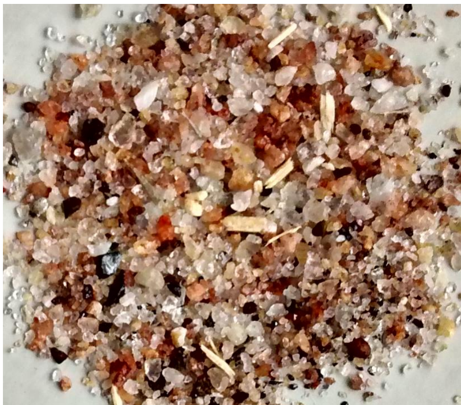
Figura 4.5 - Contaminação existente na matéria-prima de partida (RMC)
