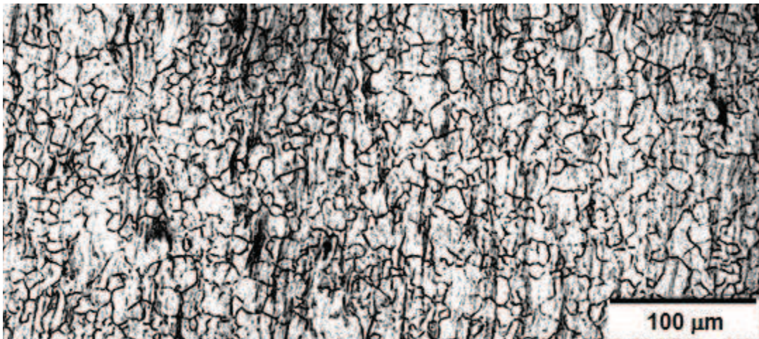
(d) T = 1050^{\circ}\text{C} , D = 7,51\mu\text{m} , \varepsilon = 4,0
