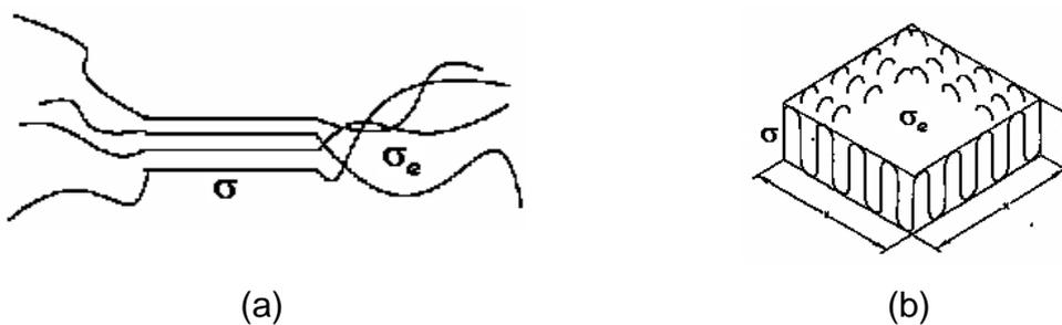
Figura 2.16 Tipos de núcleos (a) fibrilar (b) com dobras [59];  $\sigma_e$  e  $\sigma$  é a energia livre superficial de final de cadeia e lateral, respectivamente.
