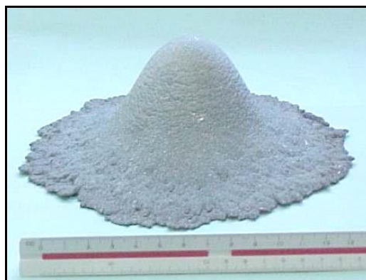
Figura 2.12: Foto de um depósito típico obtido através de conformação por spray ilustrando a geometria de uma distribuição Gaussiana [16].
