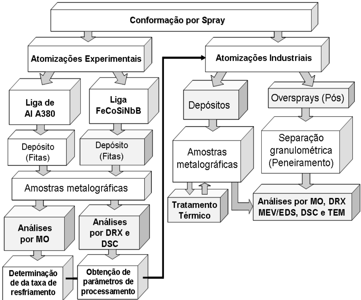
Figura 4.7: Fluxograma da segunda etapa do trabalho, apresentando seqüência de análises realizadas nos materiais obtidos por conformação por spray em escala experimental e industrial.
