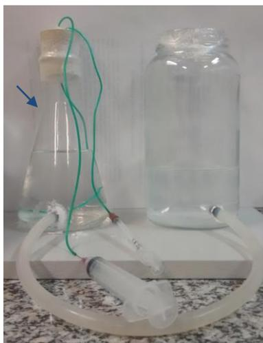
**Fig 25.** Reator para produção de etileno. À esquerda, indicado pela seta, o etileno produzido no erlenmeyer e aprisionado pela água do sistema.
