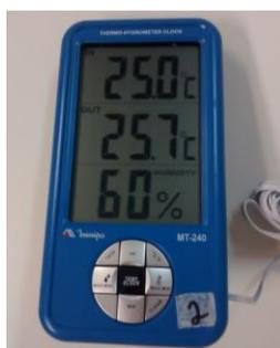
**Fig 14.** Termo higroômetro utilizado para monitorar temperatura e UR ao longo dos experimentos.
