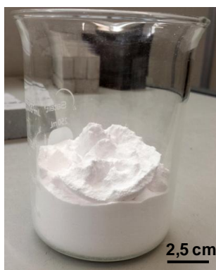
Figura 6.24. Foto de uma pedra formada após a calcinação da alumina A-1 na presença de \text{AlF}_3 .
