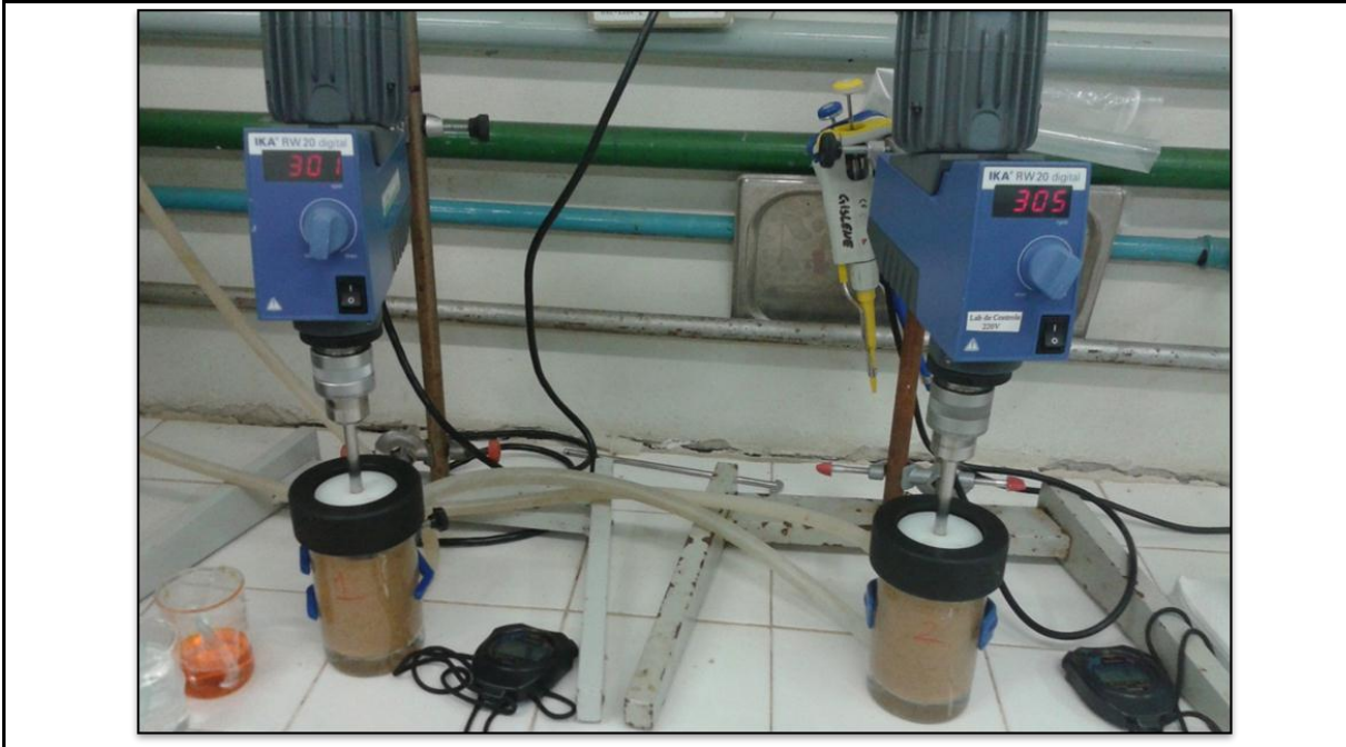
Figura 13 – Foto do reator convencional com tampa, aquecido por banho termostático e agitado mecanicamente, utilizado nas reações de hidrólise da casca de soja com endoxilanase solúvel.
