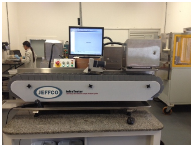
FIGURA 6.4: Espectrofotômetro NIR acoplado a esteira para análise de material desfibrado de cana-de-açúcar.
