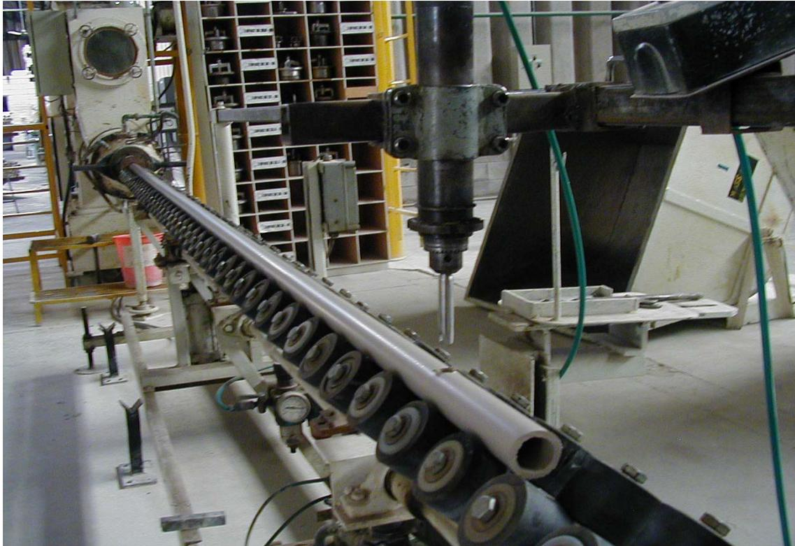
Figura 4.3 Processo de extrusão dos rolos cerâmicos em extrusora Larker
