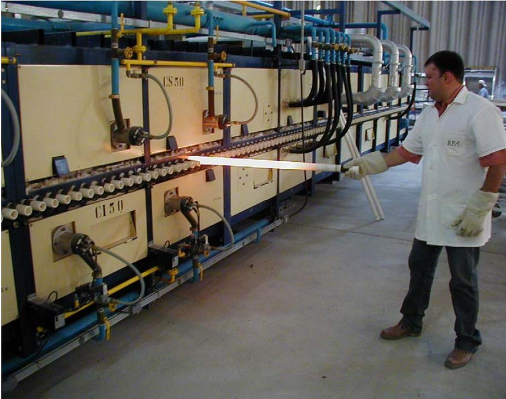
Figura 4.16 Retirada do rolo cerâmico à temperatura de trabalho
