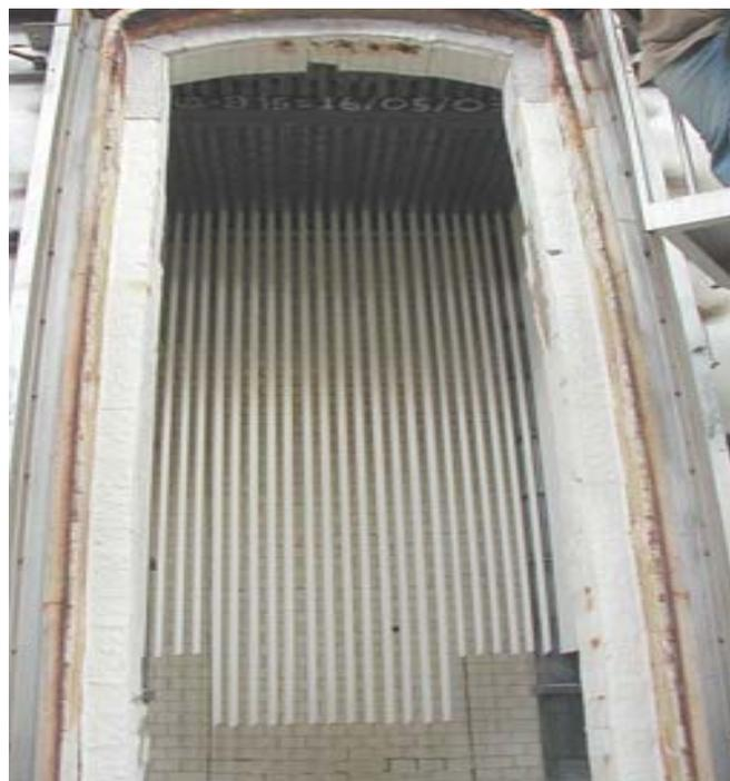
Figura 4.4 Processo de enforna dos rolos cerâmicos em Forno Wistra
