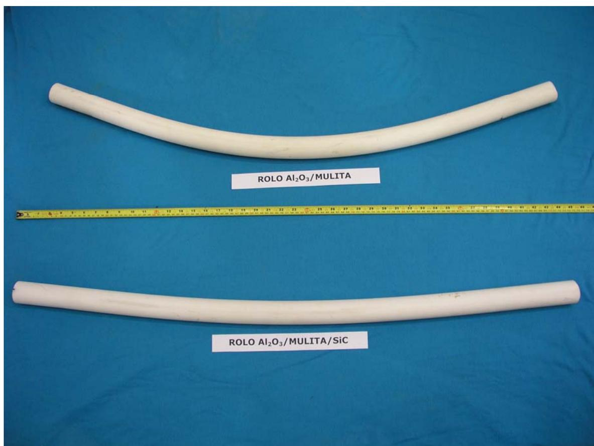
Figura 4.9 Rolos cerâmicos após ensaio de flambagem
