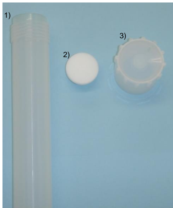
FIGURA 1.4 - Frasco modelo MarsXpress (CEM), composto por: liner de reação (1), selo de alívio de pressão (2) e tampa (3).
