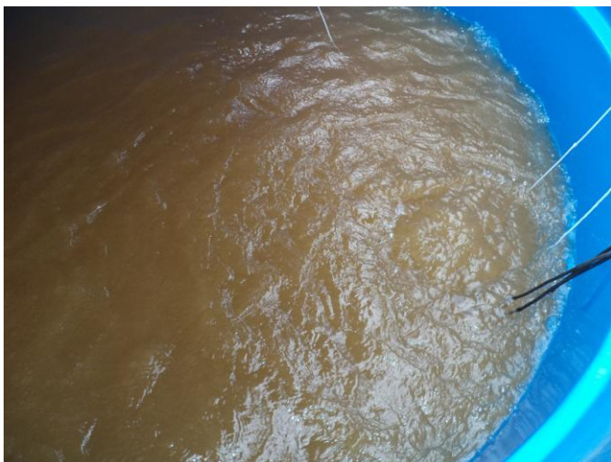
Figura 26. Mistura da água utilizando-se bomba para homogeneizar o material particulado.
