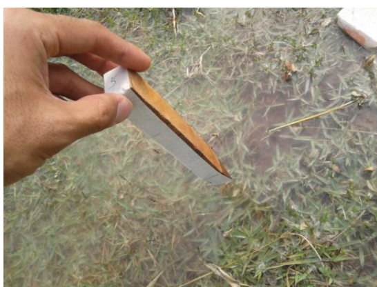
Figura 25. Medição da altura da lâmina de água com o auxílio de uma estaca de madeira, realizada para os pontos amostrais (0,15, 30, 45, 60, 75, 90m).
