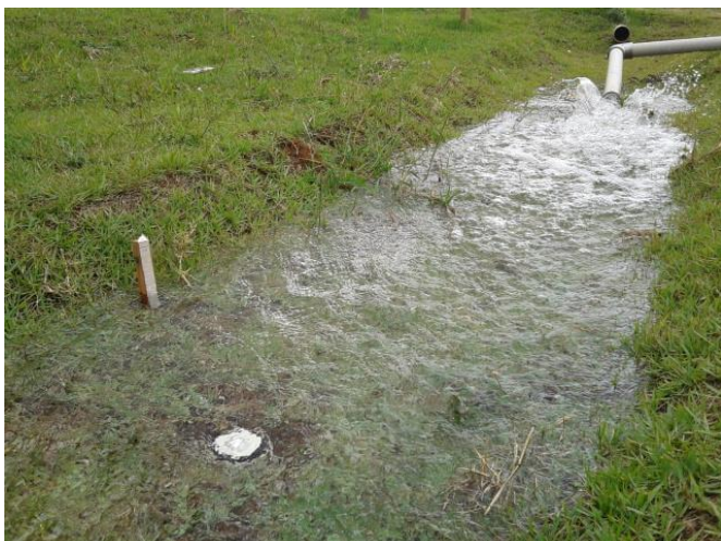
Figura 4. Entrada da água utilizada para simulação de escoamento superficial no canal.
