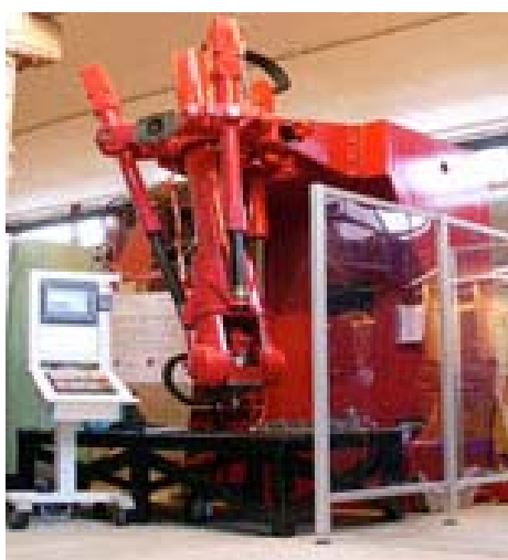
Figura 2.1 Sistema robotizado de Friction Stir Welding . [Cortesia GKSS-FORSCHUNGSZENTRUM]
