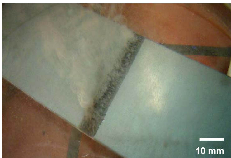
Figura 4.8 Junta soldada por FSW da liga 2024-T351 durante o ensaio de corrosão por esfoliação.
