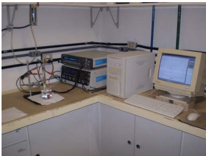
Figura 3.4 Equipamento utilizado no ensaio eletroquímico de polarização.
