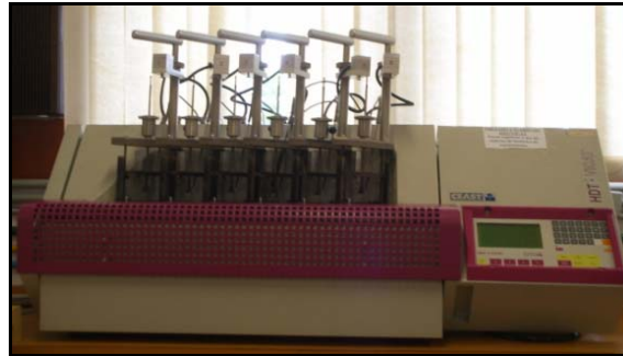
Figura 3.4 Aparelho HDT-CEAST, modelo HDT 6 VICAT P/N 6921.000.
