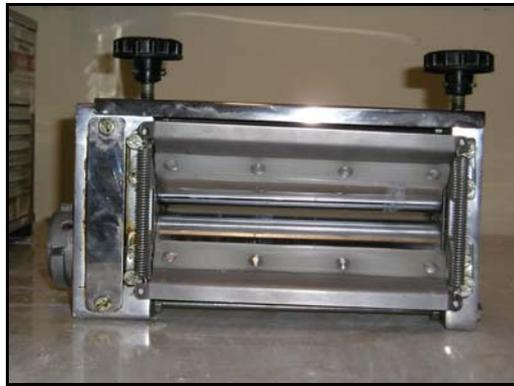
Figura 3.2 Calandra utilizada para a laminação a frio.
