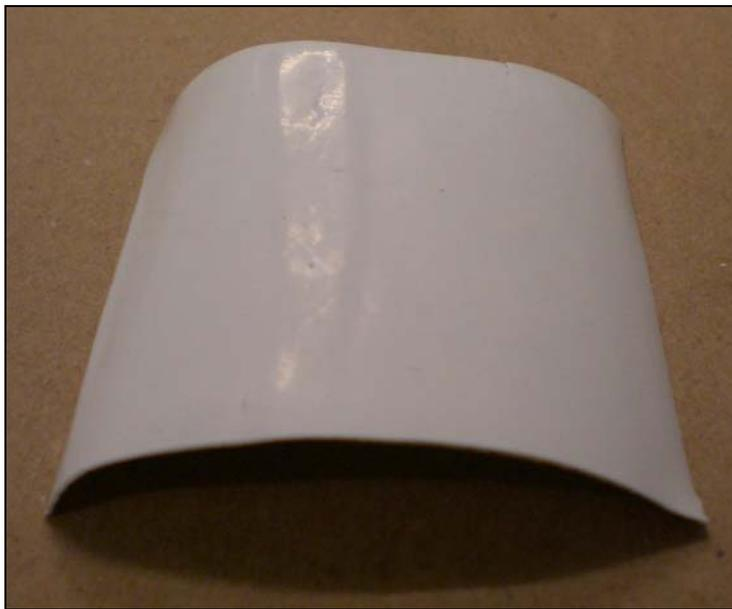
Figura 4.12 Substrato de alumina conformada por rolos a frio e a verde, com empenamento devido às retrações de secagem.
