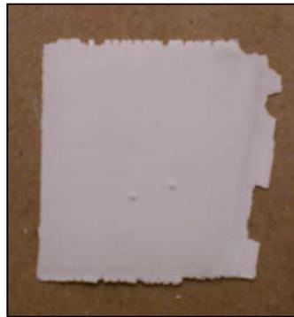
Figura 4.35 Amostra de alumina conformada por rolos a frio por meio da junção de 3 substratos com espessura de 0,25 mm com velocidade dos rolos de 15 rpm e queimadas a 1600°C.
