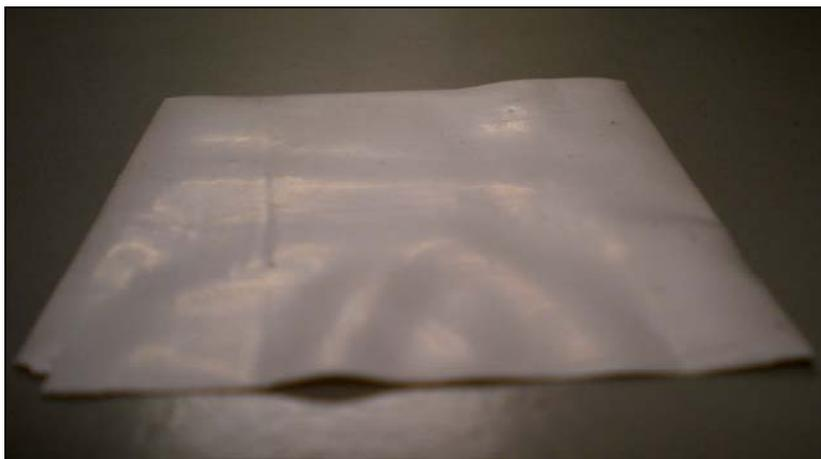
Figura 4.11 Substrato de alumina conformado por rolos a frio com defeitos superficiais após a queima a 1600°C.
