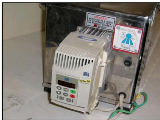
Figura 3.3 Dispositivo inversor de frequência, responsável pelo controle da velocidade do moinho de facas e do dispositivo de laminação.
