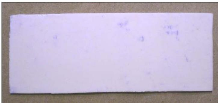
Figura 4.15 Substrato de alumina conformado por rolos a frio com velocidade de 8 rpm e com 0,74 mm de espessura submetida ao ensaio de líquidos penetrantes com absorção de azul de metileno ao longo da superfície.
