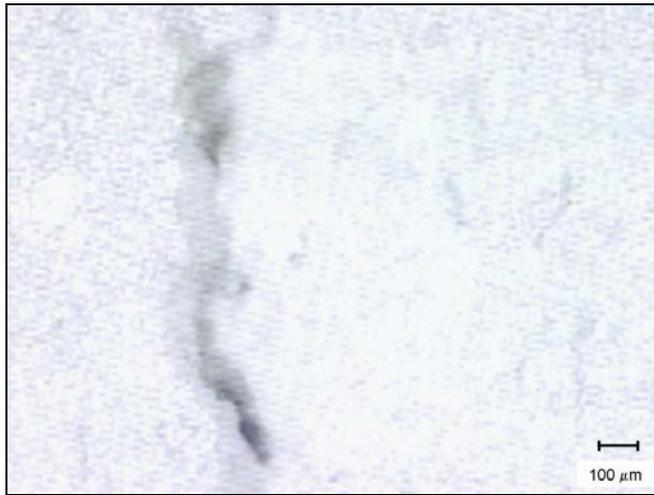
Figura 4.17 Micrografia óptica com 50x de magnificação do substrato de alumina com 0,74 mm de espessura conformado por rolos a frio com velocidade de 8 rpm e queimado a 1600°C, submetido ao ensaio de líquidos penetrantes.
