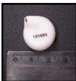
Figura 3. Datalogger (SubCue, Calgary, AT, CA) implantado na cavidade abdominal dos ratos para medida de temperatura corporal.
