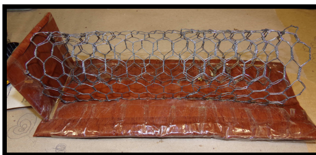
Figura 6. Tubo de contenção.
