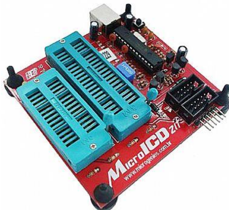
FIGURA 3.6 - Placa de gravação de microcontrolador Microgênio®, modelo MicroICDzif.
