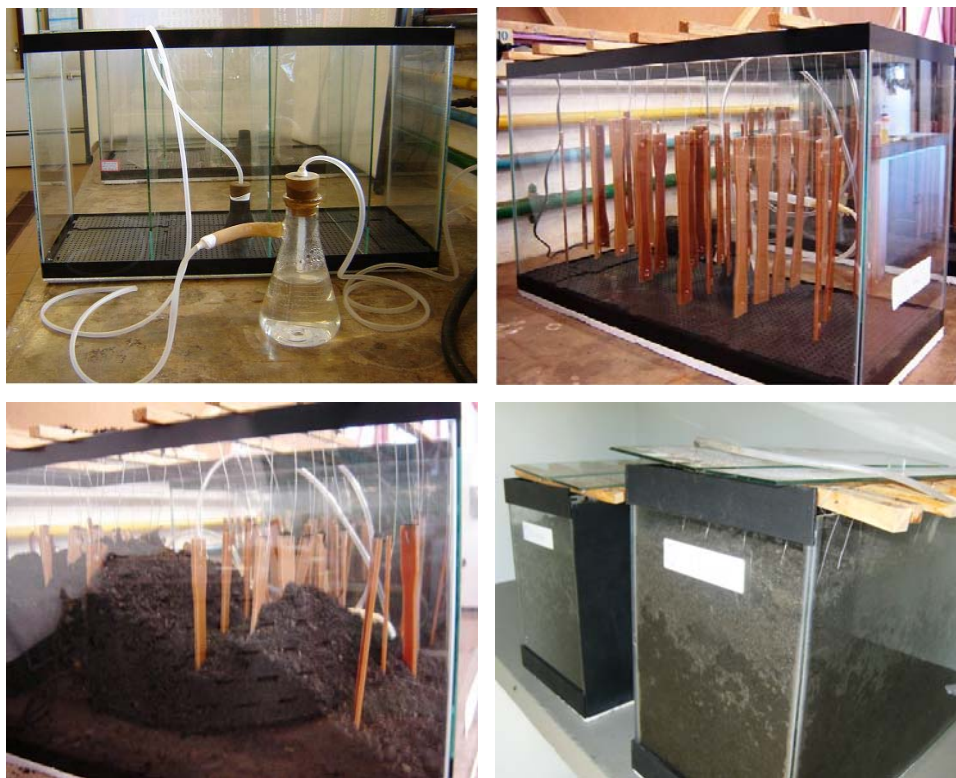
Figura 3.3 Fotografias da instalação dos sistemas de biodegradação.
