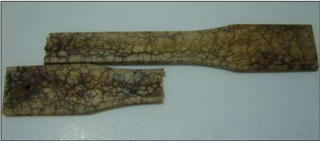
Figura 5.18 Corpo de prova de PLA + amido biodegradado por 120 dias em composto orgânico.
