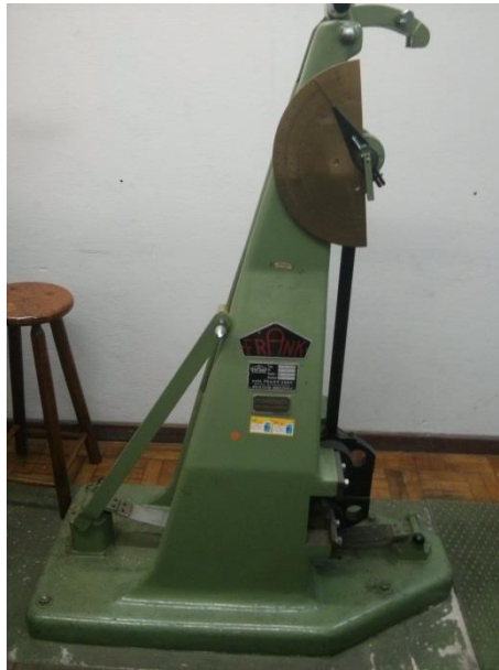
Figura 37. Equipamento de ensaio de impacto Frank, modelo 580M. Carga do pêndulo de 30 kg.
