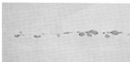
Figura 15. Micrografia eletrônica de varredura mostrando inclusões de óxidos na interface de um tubo co-extrudado de aço T11 e aço inox 310 [31].
