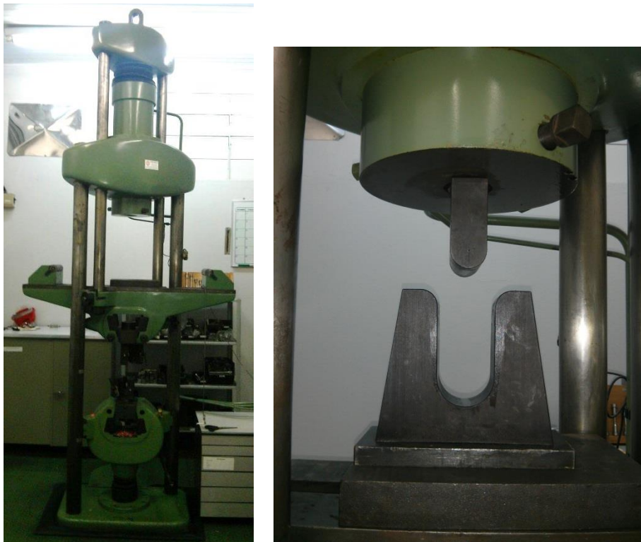
Figura 40. Máquina universal de ensaios Frank, modelo UPM 70 (esquerda) e montagem do sistema cutelo e matriz de dobramento na máquina (direita).
