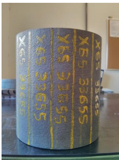
Figura 29. Bucha do tubo monocamada pronta para ser cortada em tiras (à esquerda) e tira do tubo bimetálico, retirada do meio do tubo (à direita).
