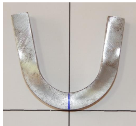
CP monocamada, solubilizado à 1200°C/1h e revenido à 650°C/1h
