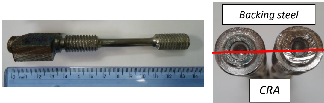
Figura 35. Corpo de prova ASTM E8 número 2 Tipo II, usinado a partir de uma tira longitudinal do tubo bimetálico bruto. À esquerda, vista lateral. À direita, vista de topo.
