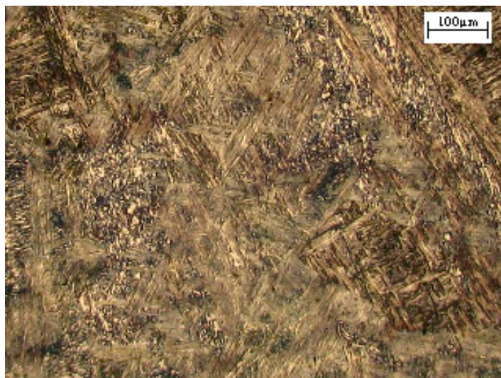
Figura 4.20 CP8 temperado e duplo revenido. Aumento de 115 vezes.
