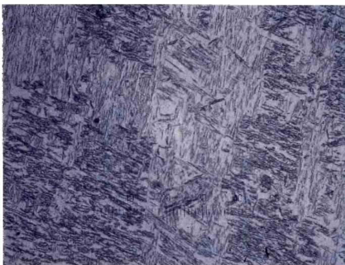
Figura 2.45 Estrutura do aço inoxidável CA6NM temperado e revenido, ataque Pícrico-HCl. Microscopia ótica com aumento de 200 vezes.
