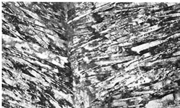
Figura 2.10 Martensita em ripas de um aço carbono temperado[13].
