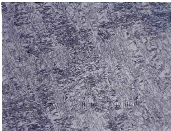
Figura 2.44 Estrutura do aço inoxidável CA6NM temperado e revenido, ataque Pícrico-HCl. Microscopia ótica com aumento de 100 vezes.
