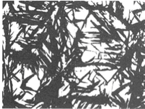
Figura 2.19 Martensita em placas e austenita retida no SAE1080[13].
