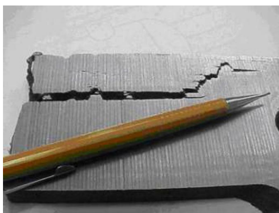
Figura 3.13 Seção transversal de uma chapa mostrando um dano de trincamento induzido por hidrogênio [36].
