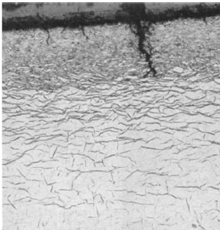
Figura 3.31 Exemplo ilustrando um dano por hidrogênio através do mecanismo de hidretação [22].
