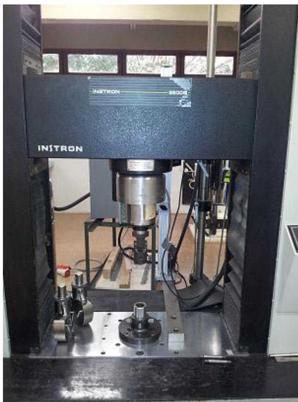
Figura 5.6 Máquina de ensaio de tração utilizada nos experimentos com baixa velocidade do travessão para avaliar as propriedades mecânicas dos materiais estudados.
