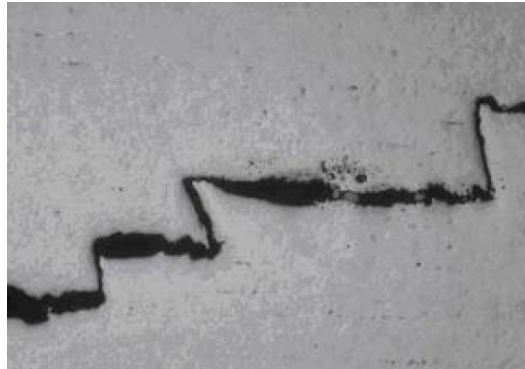
Figura 3.15 Fotomicrografia ampliada mostrando a natureza da trinca em degraus para o dano de trincamento induzido por hidrogênio [36].
