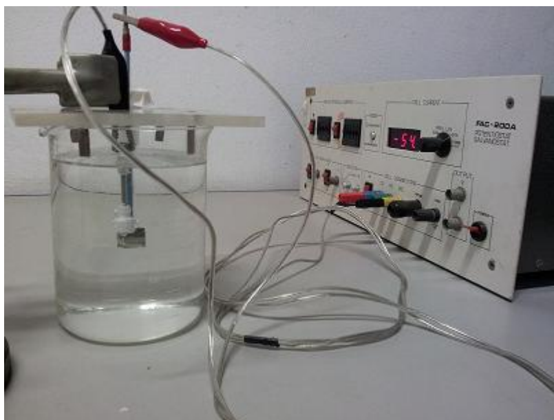
Figura 5.5 Ilustração mostrando a fonte (FAC-Newton, modelo 200 A) utilizada nos processos de hidrogenação, o corpo de prova (isolado com fita de vedação) e o contra-eletrodo de platina.
