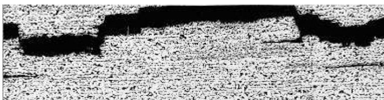
Figura 3.14 Fotomicrografia com grande ampliação de um dano de fissuração induzida por hidrogênio [36].
