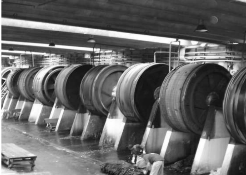
Figura 2.4 Bateria de fulões [3].
