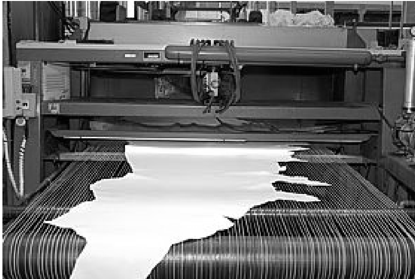
Figura 2.9 Máquina de pintura e brilho por spray [5].
