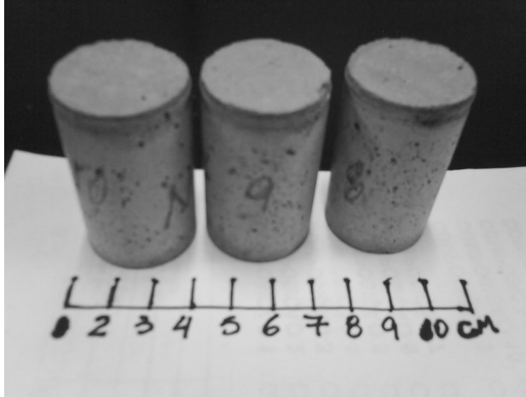
Figura 3.8 Corpos-de-prova confeccionados utilizando argamassas de cimento Portland com adições de resíduo (serragem de couro) previamente tratado em soluções químicas.
