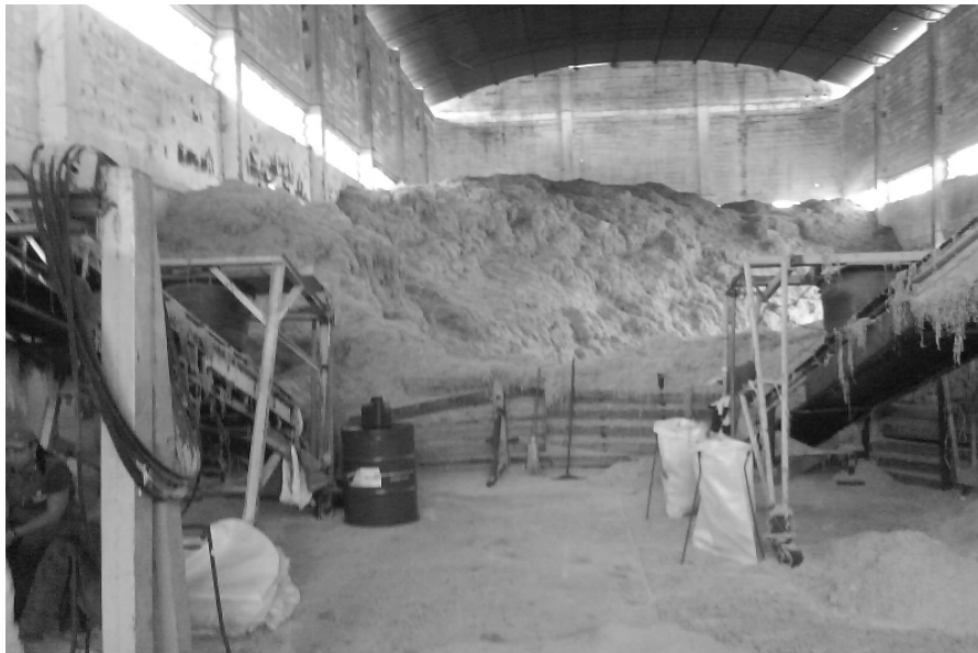
Figura 2.12 Serragem de couro gerada na máquina de triturar.
