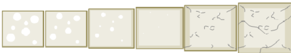
Figura 4.7 Esquema representativo da variação da microestrutura do material com o decorrer dos dias.
