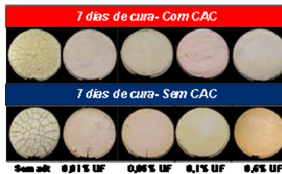
Figura 4.63 Fotos do trincamento das amostras em função do teor de LiF para suspensões de síter de magnésia (M20) 88%p de sólidos com e sem a presença de 5%p de CAC, hidratadas por 7 dias 50°C.
