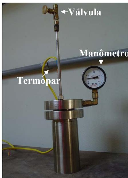
Figura 3.2 – Autoclave confeccionado para realização de tratamentos hidrotermais nas suspensões coloidais de SnO<sub>2</sub> nanocristalino.
