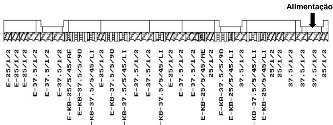
Figura 3.43 Perfil da extrusora dupla rosca para melhorar dispersão de pigmentos [53]
