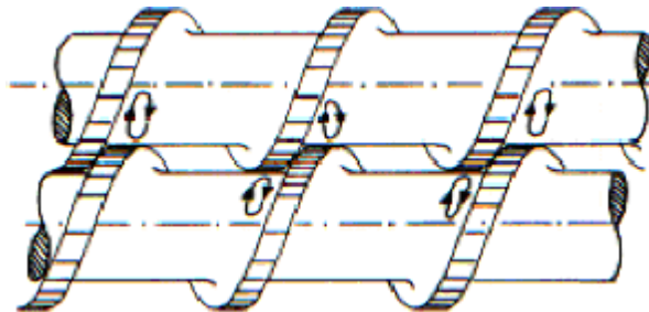
Figura 3.14 Fluxo oscilatório no flanco do filete passivo de uma extrusora de rosca dupla co-rotacional [22]
