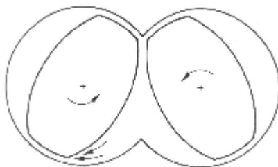
Figura 3.23 Dispositivo de mistura em fluxo elongacional, elemento de mistura em extrusora dupla rosca [27]
