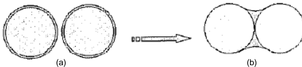
Figura 3.6 Ilustração esquemática da formação de pontes líquidas (a) área total ar/água. Interface é A_{SEPARADO} (b) área total ar/água. Interface é A_{CONTATO} . [11]
