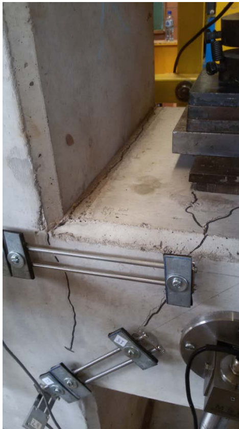
Figura 5.19 - Ruptura do modelo A
