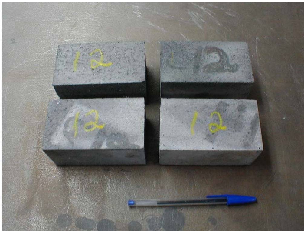
Figura 3.4 – Fotografia mostrando as quatro partes obtidas do tijolo padrão cortado para posterior ensaio de oxidação, segundo Norma ASTM C 863 [65].
