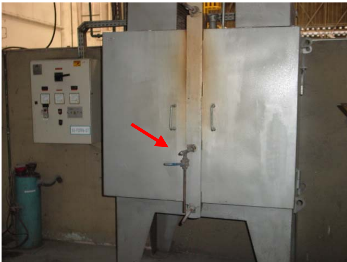
Figura 3.7 – Fotografia mostrando exterior do equipamento, com destaque para o tubo de aço responsável pelo fornecimento de vapor d'água.
