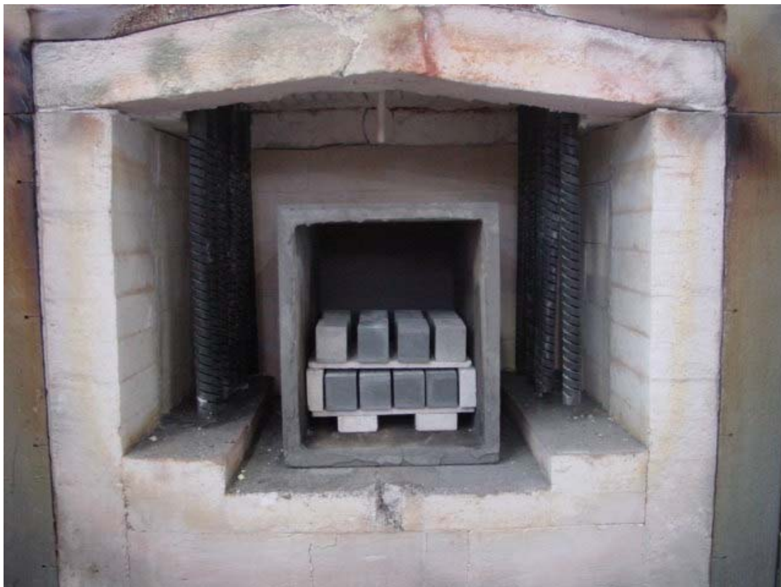
Figura 3.5 – Fotografia mostrando o esquema de carregamento das amostras no forno, com câmara fechada de carbetto de silício e resistências elétricas.
