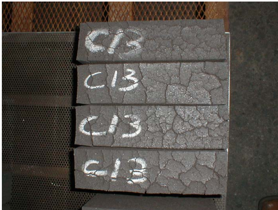
Figura 4.2 – Fotografias mostrando as trincas geradas após o processo de secagem à temperatura ambiente dos tijolos obtidos para a Composição 13 – 1,0% Óxido de Boro; (A) tijolo isolado; (B) todos tijolos obtidos.
