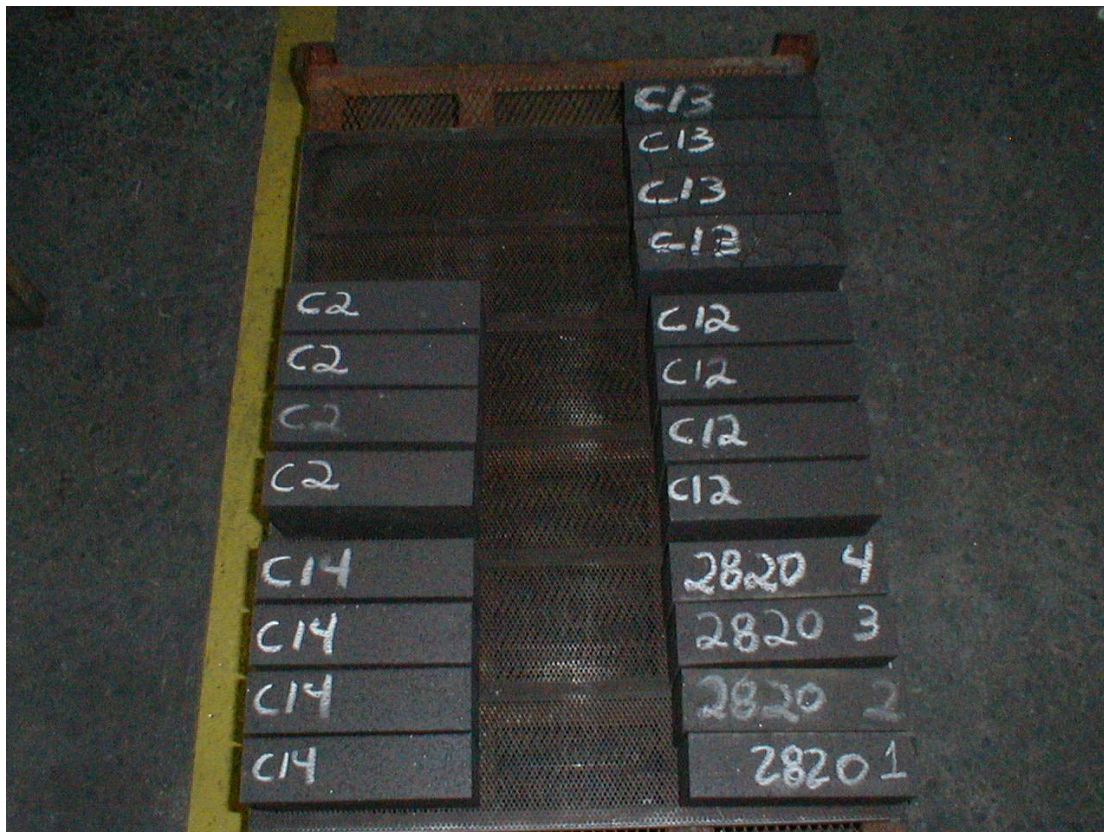
Figura 3.2 – Fotografia mostrando os tijolos refratários sobre pallet metálico utilizado durante o processo de secagem.
