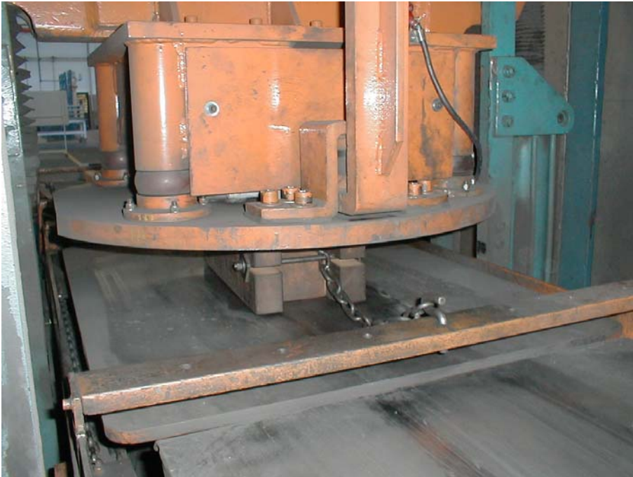
Figura 3.1 – Fotografias mostrando o equipamento e o aparato para prensagem dos tijolos utilizados no trabalho; (A) Prensa Industrial Maxibrator; (B) Aparato de prensagem e molde (Saint-Gobain - Planta Vinhedo).
