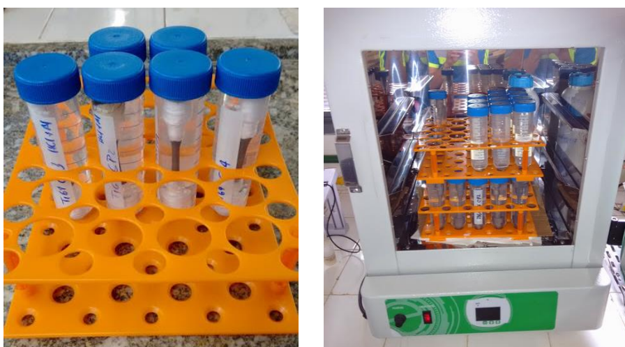
Figura 4.3 a) Corpos de prova numa solução de de NaOH a 10 \text{ mols.L}^{-1} , b) estufa de secagem.
