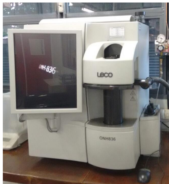
Figura 4.4 Analisador de elementos Leco ONH836, para determinar a quantidade do hidrogênio.
